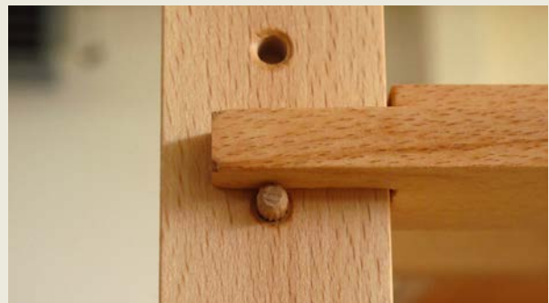
Detail: Ladenlaufleiste mit Dübel auf Rahmen
