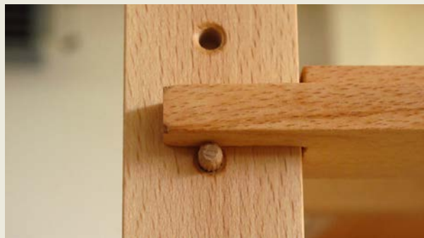
Detail: Ladenlaufleiste mit Dübel auf Rahmen
